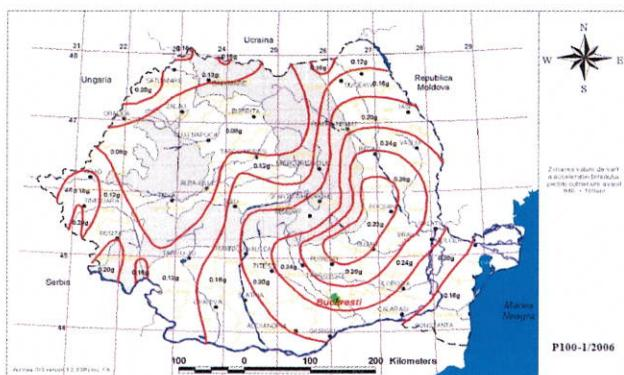
Fig.3.2 Zonarea teritoriului României în termeni de valori de vîrf ale accelerării terenului pentru proiectare,  $g_f$  pentru extremitate având intervalul mediu de recurentă  $I_{MR} = 100$  ani
